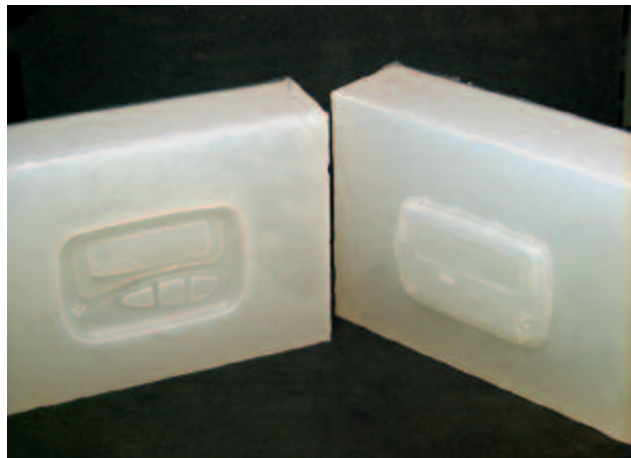
Bild 3: Silikonabguss des Modells
