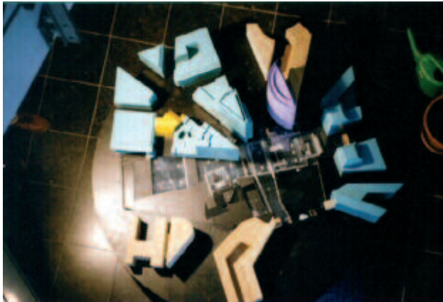
Bild 1: Bauwerksaerodynamische Modelluntersuchung am Regionalbahnhof Potsdamer Platz, Berlin
