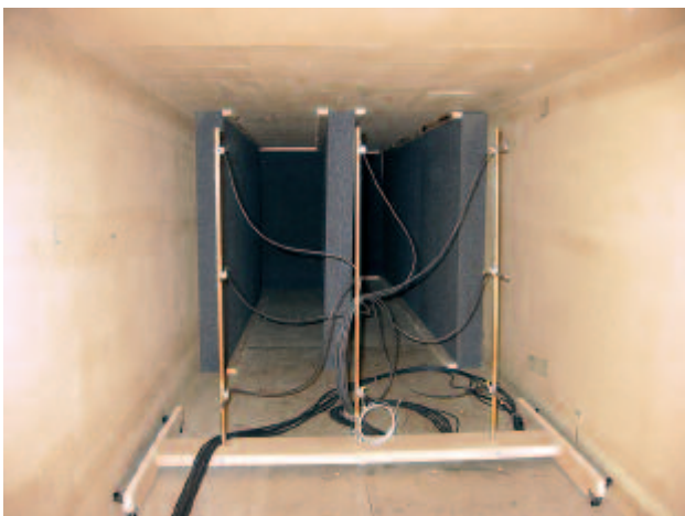
Bild 4: Blick in den Schalldämpfer-Prüfstand auf dem Mikrofonschlitten (8 Mikrofone); Kanalquerschnitt 1 m x 1 m
