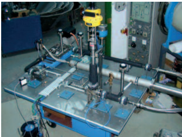
Bild 11: Prüfstand für Kryopumpen
