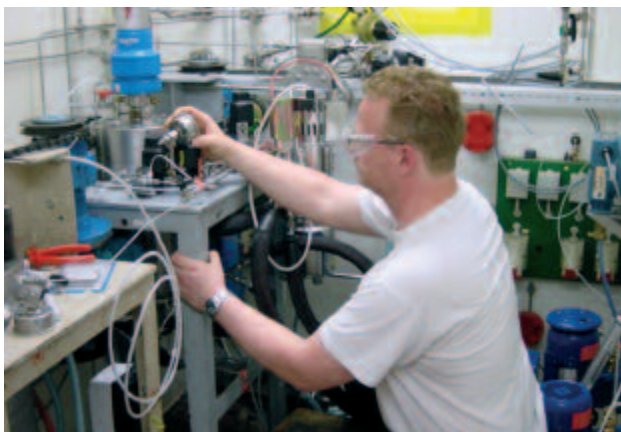
Dipl.-Ing. Andreas Künzel beim Aufbau der Hochdruckpolymerisationsanlage zur Herstellung von Ethylen-Acrylat-Nanopartikeln
