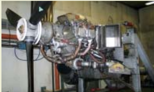
Diesel-Flugmotor SMA 305 auf dem Propellerprüfstand der Hochschule
