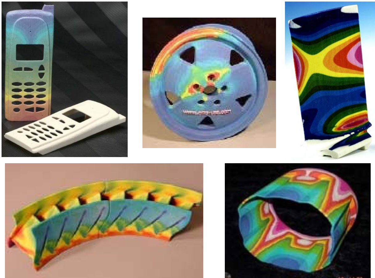
Bild 8 Farbige 3D Printing Bauteile als 3-dimensionales Display der Ergebnisse von Simulationsrechnungen
