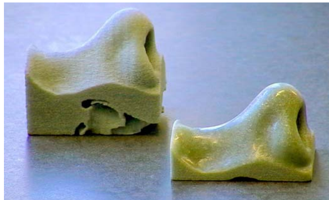
Bild 13 Farbige 3D Printing Bauteil nach dem Bauprozess (links) und nach dem manuellen Finishing (rechts)
