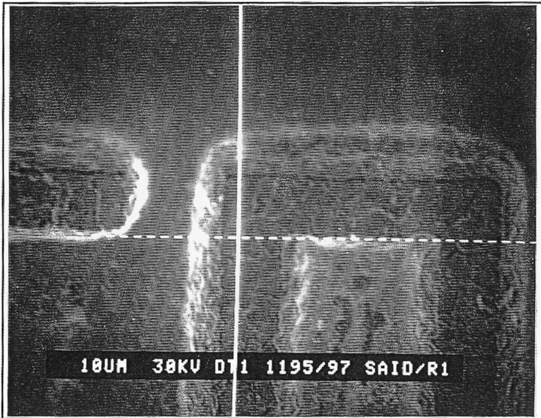
Abb. 36: Rasterelektronenmikroskopische Aufnahme einer LU - Struktur in einen keramischen Grünfolienpreßling,  $10 \text{ Jcm}^{-2}$ , 2000 Pulse.
