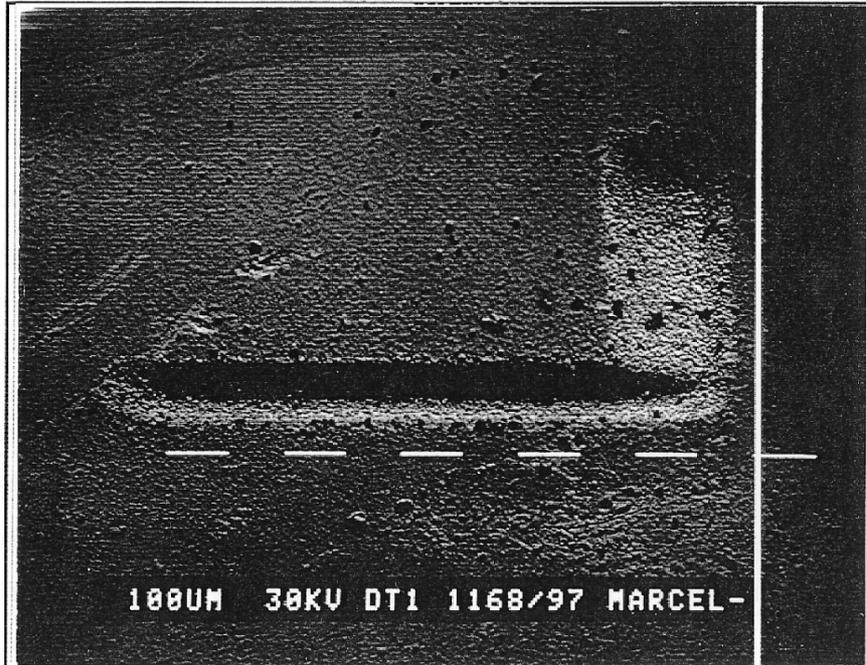
**Abb. 22:** REM - Aufnahme eines optimal bearbeiteten Buchstaben "L". Scangeschwindigkeit 2 mm/s, Pulsfrequenz 200 Hz.
