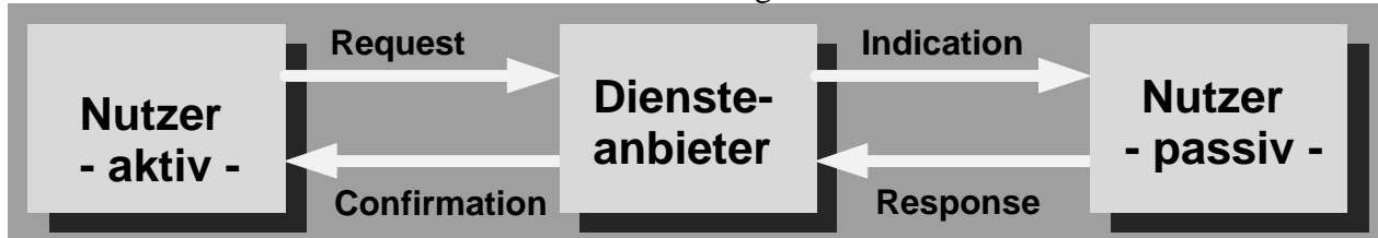
Bild 2: Prinzip eines Ablaufes für alle Dienste-Kontroll-Elemente
