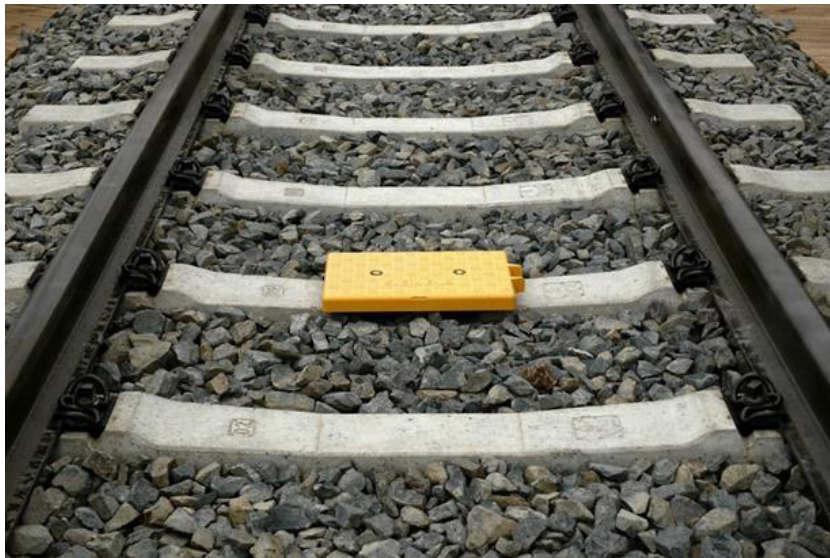
Bild 2-2 ETCS-Euro-Balise im Gleis [VDB-22]
