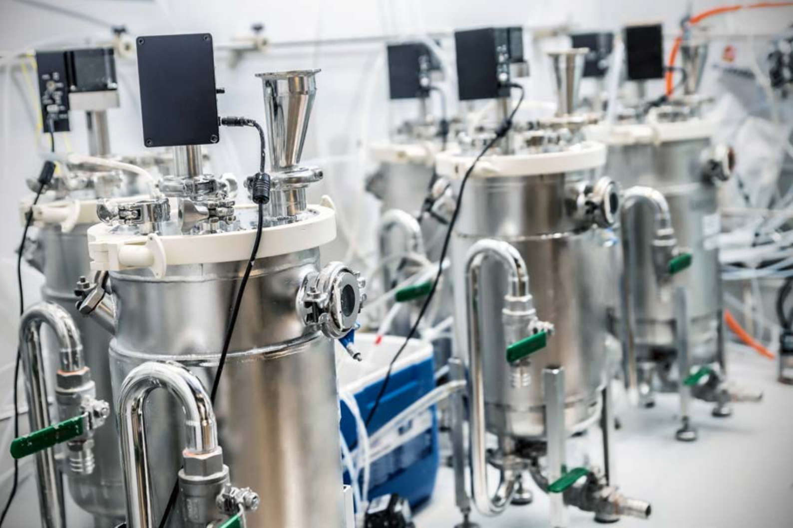
In den Gärbehältern wird die Monovergärung der Papierreste untersucht
