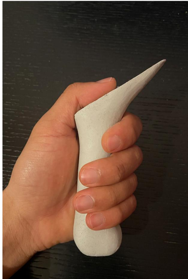
Die Claymodelle wurden nicht komplett ausgearbeitet, sondern dienten lediglich zur Übertragung von Ergonomie in das Verständnis. Auch wenn in diesem Beispiel keine User Tests zur Handhabung von Kindern durchgeführt wurde, diente dies als grobe Richtung.
