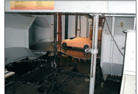
Bild 8: Aerodynamische Untersuchungen am 1 : 5-Modell
