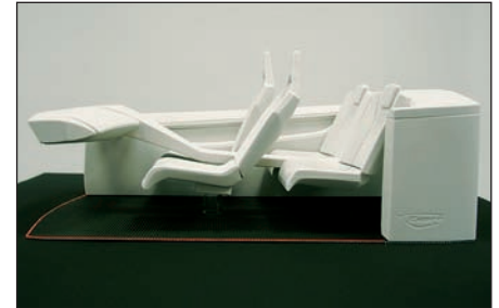
Bild 5: Interiormodell aus PU (1 : 5)
