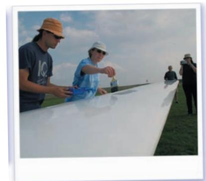
Bild 6: Auftragen des Lackes
