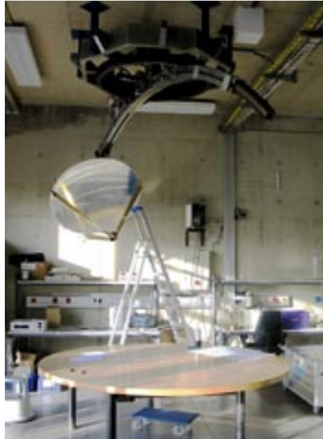
Abb.: „Die künstliche Sonne“, ein Zweiachssystem mit angehängtem Strahler mit Parabolreflektor und Probenstisch.
