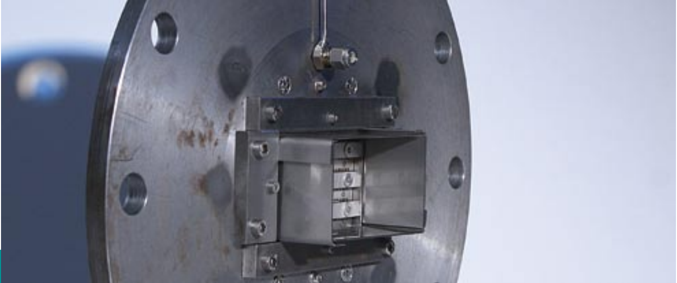
Mithilfe des Probekenners lässt sich in vielen Versuchen die beste Einstellung für die spätere Brennkammer ermitteln.
