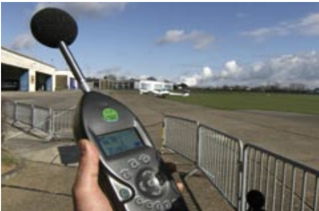
Das Messgerät macht den Fluglärm sichtbar.
