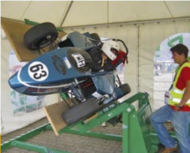
Beim Kipptest sah noch alles gut aus: 60 Grad Neigung waren kein Problem für den grünen Einsitzer
