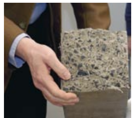
...zeigt ein Stück Kunststofffaserbeton
