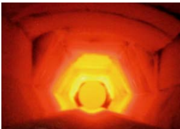
Abb. 1 | Blick in eine Produktionsanlage zur Erwärmung von Kupferpressbolzen
