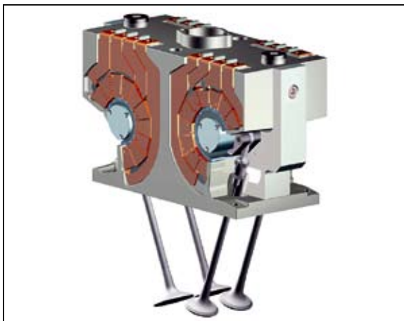
Abb. 1 | Vollvariabler elektromechanischer Ventiltrieb des 1-Zylinder Forschungsmotors
