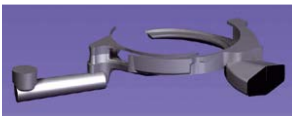
Abb. 2 | Für die CFD-Berechnung aufbereitetes CAD-Modell des vom Öl durchflossenen Volumens
