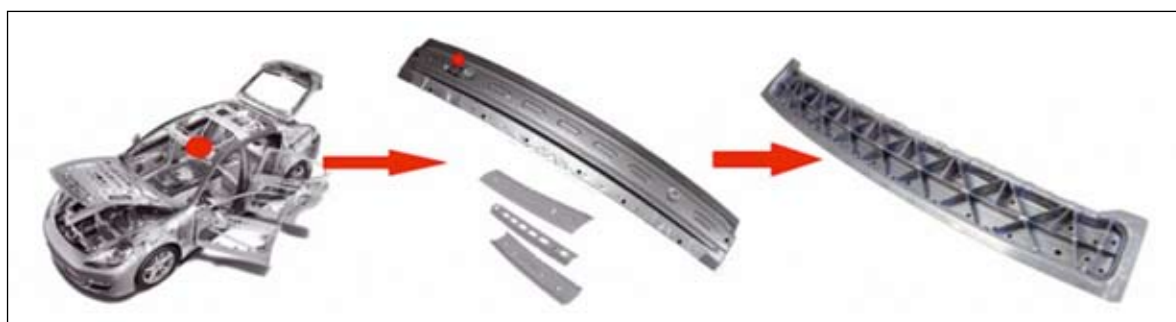
Abb. 3 | Substitution eines konventionellen, 3-schaligen Dachquerträgers durch eine Verbundguss-St-LM-Hybriden
