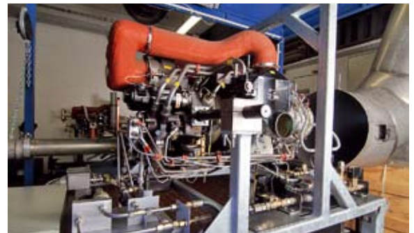
Abb. 1 | Prüfstand für Wasserstoffgasturbinen
