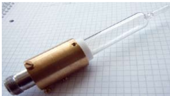
Abb. 2 | Erste 50-W-Mikroplasma-Beamerlampe (UHP-MPL), die von Philips gefertigt wurde
