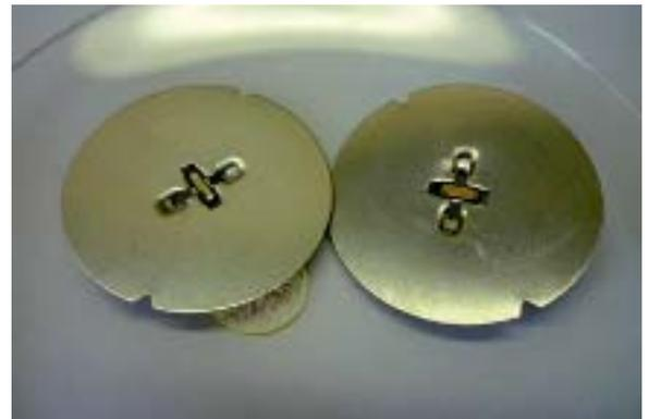
Abbildung 3 | Technische radioaktive Quellen; die Trägerscheiben haben einen Durchmesser von ca. 5 cm, das radioaktive Präparat befindet sich in dem Metallstreifen im Zentrum.
