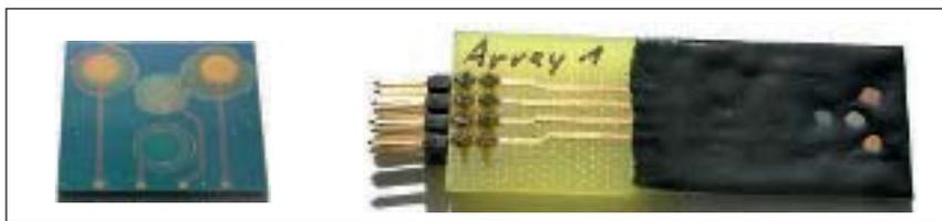
Abb. Sensorchip mit vier Chalkogenidglaelektroden (links) und verkapseltes und kontaktiertes Sensorarray auf einem Leiterplattensubstrat (rechts).
