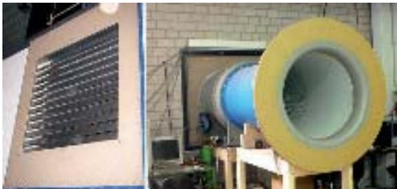
Zu prüfende Regelklappe (links) und Ventilator mit Einlaufdüse (rechts) der IFI-Differenzdruck-Prüfanlage
