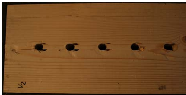
Bild 9: Blockscheren in den Decklagen
