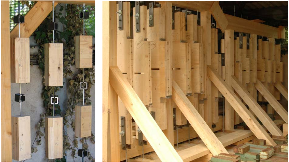
Bild 12: Langzeitversuche mit auf Herausziehen und mit auf Abscheren beanspruchten selbstbohrenden Holzschrauben
