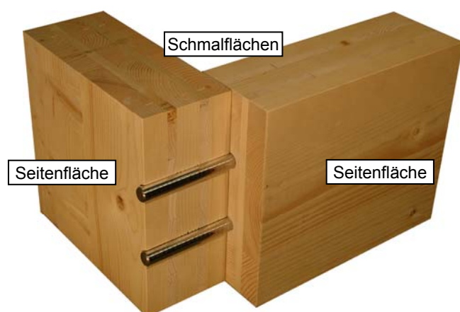
Bild 1: Geöffnete Stabdübelverbindung in Seiten- und Schmalflächen von Brettsperrholz
