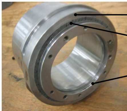
Außenring EP-Schaum Innenring mit Stellschrauben für Lagervor- spannung
