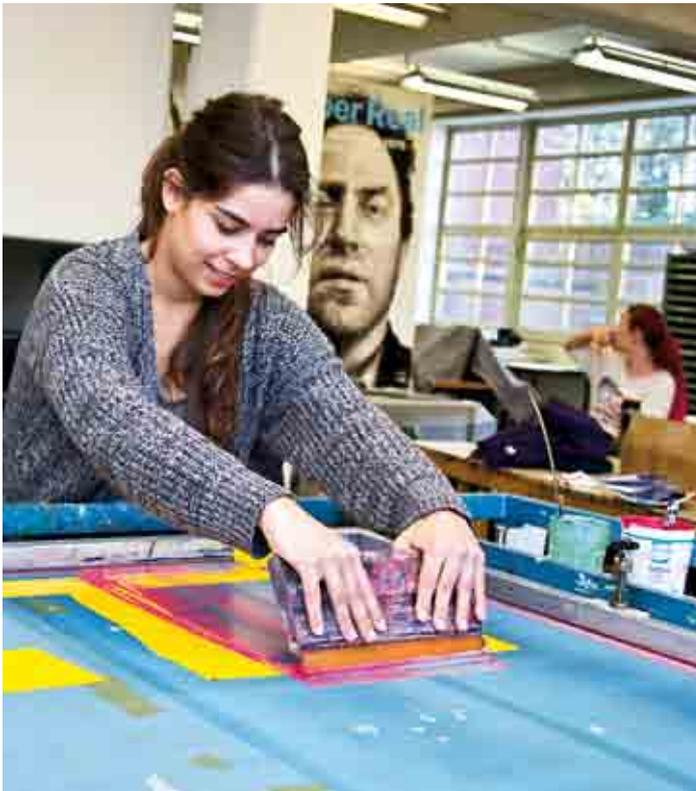
Beim Siebdruckverfahren wird mithilfe einer Gummirakel Druckfarbe durch ein feinmaschiges Gewebe auf Papier oder Textil gedruckt
