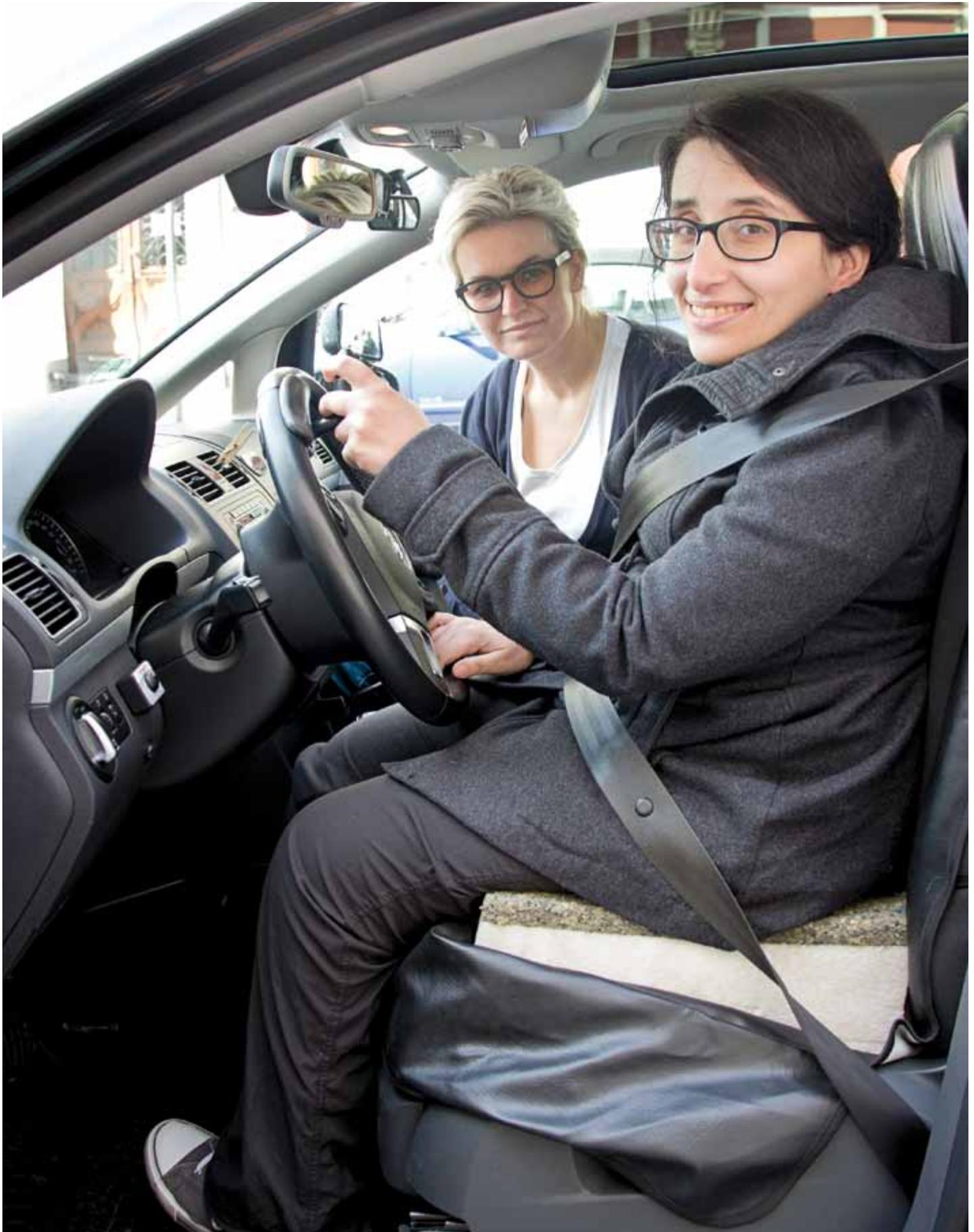
*Sima Surkamp fährt mit einem mechanischen Handbediengerät zur Bedienung von Gas und Bremse per Hand und mit einem Multifunktions-lenkraddrehknopf (MFD) mit Sekundärfunktionen zur Bedienung von z.B. Blinker, Scheiben-wischanlage, Hupe*
