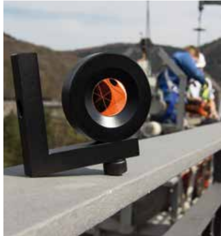
Mit dem Kran werden die Vermessungsingenieure an der Mauer herabgelassen, um die Prismen zu installieren, die später vom Messinstrument mit einem Lichtstrahl angepeilt werden
