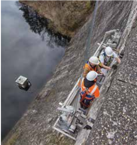
Mit dem Kran werden die Vermessungsingenieure an der Mauer herabgelassen, um die Prismen zu installieren, die später vom Messinstrument mit einem Lichtstrahl angepeilt werden
