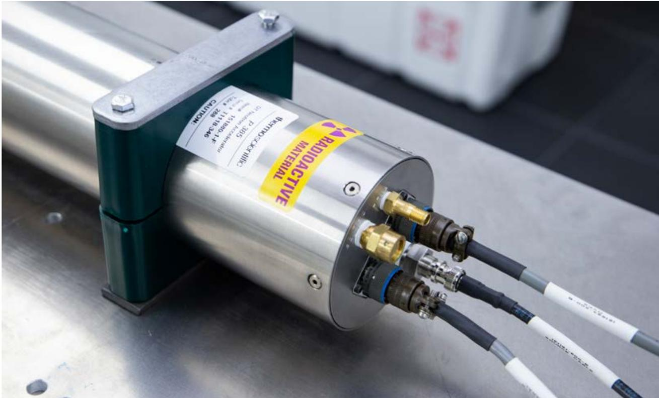
Das Stolberger Unternehmen richtet zu diesem Zweck einen Demonstrator ein, mit dem der Einsatz der Messanlage unter Realbedingungen getestet werden kann. Neutronenquelle und Detektor sind in einem variablen Abstand von bis zu zwei Metern positioniert, der zu untersuchende Referenzkörper befindet sich dazwischen. „Wir testen mit unterschiedlichen Bodentypen“, erklärt Dr. Kettler, je nach Beschaffenheit und Feuchtigkeit des Erdreichs können die Messsignale un-
