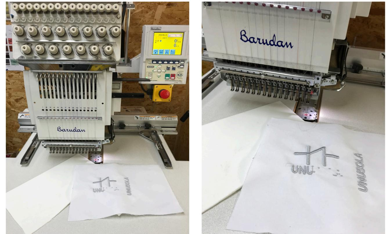
Das linke Bild zeigt den oberen Teil einer Industriestickmaschine. Auf dem Tisch der Maschine liegt ein Stück Stickschaum, sowie ein weißer Stoff mit einem Teststick des UNUSOLA Logos.
