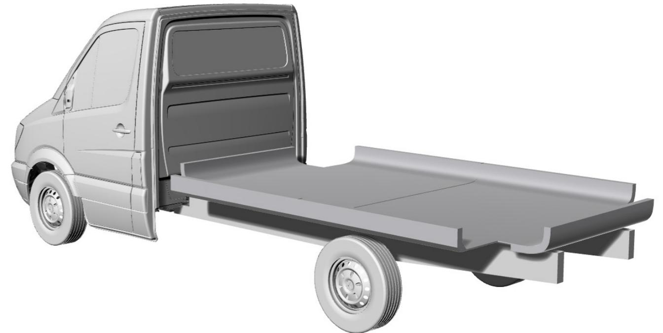
Damit die Sammelstation auf dem Transporter transportiert werden kann, gibt es für die Ladefläche eine Befestigungsplattform. Die Sammelstation passt formgenau auf die Befestigungsplattform. Für die hydraulischen Füße sind Aussparungen vorgesehen.
