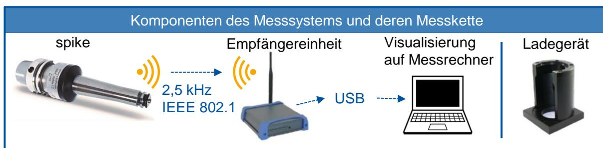
Abbildung 4.3: Messkette der Komponenten des Messsystems von pro-micron
