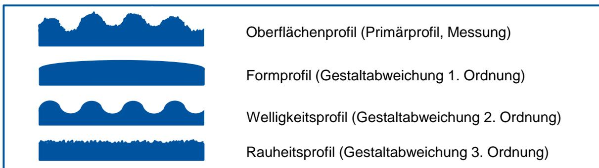
Abbildung 2.8: Überlagerung von Abweichungen am Oberflächenprofil [KEFE18, S. 112]
