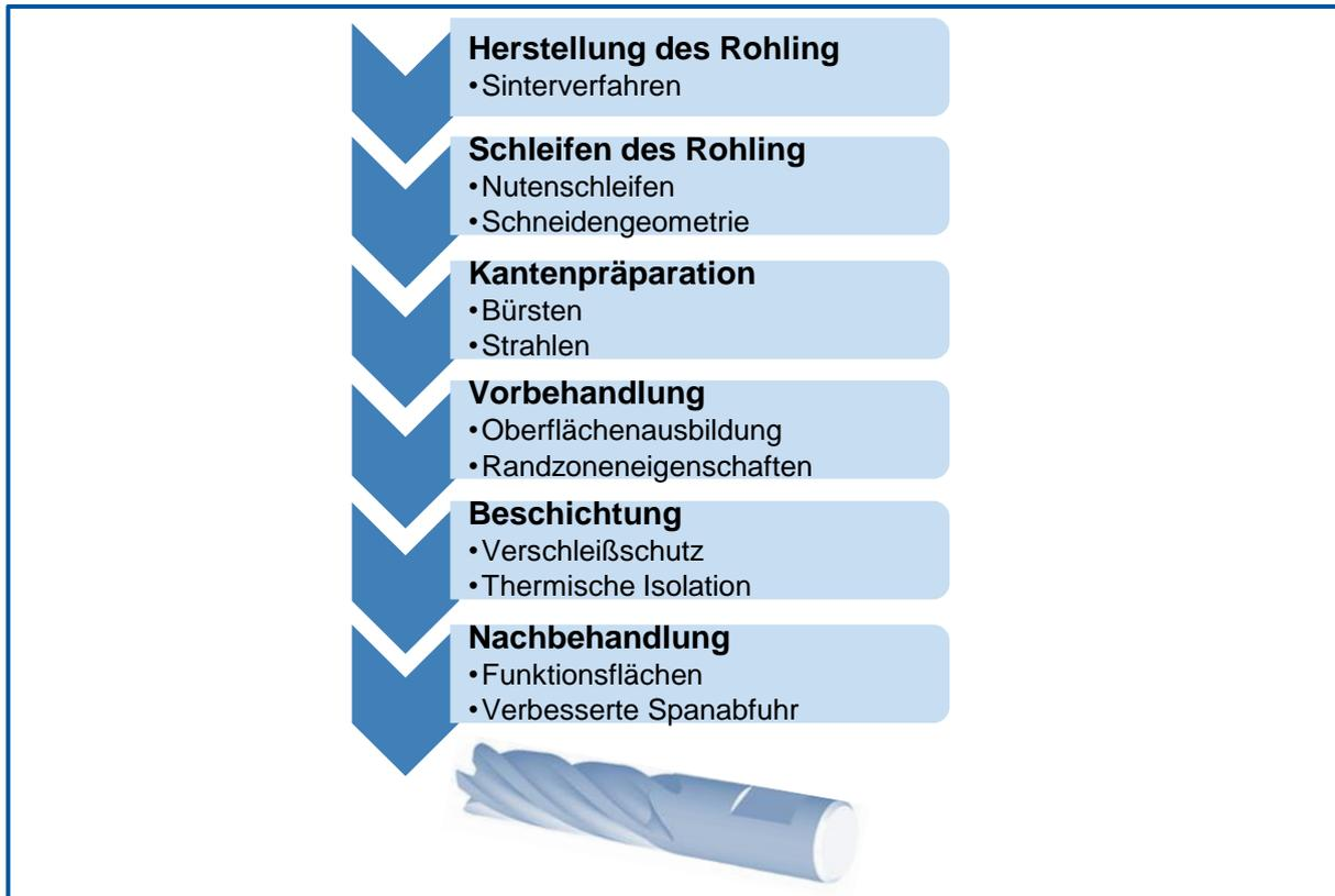
Abbildung 2.11: Prozesskette der Herstellung von Fräs Werkzeugen [FRIE02, S. 18]
