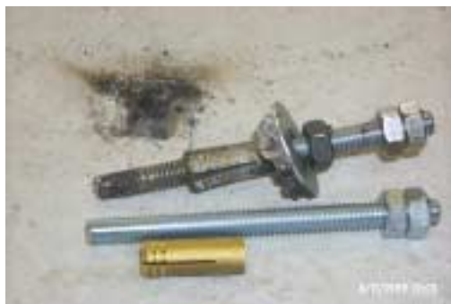
Bild 8: Gewindestange mit Metalldübel vor und nach einer Stoßstrom-Belastung 10/350 mit 100 kA Scheitelwert.
