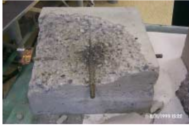
Bild 14: Prüfung der Bewehrungsstab-Kreuzung im Beton: Zerstört Prüfling C13 nach Belastung mit 3 x 100 kA 10/350.
