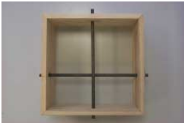
Bild 2: Prüfling Typ A: Anordnung der Bewehrungsstäbe.
