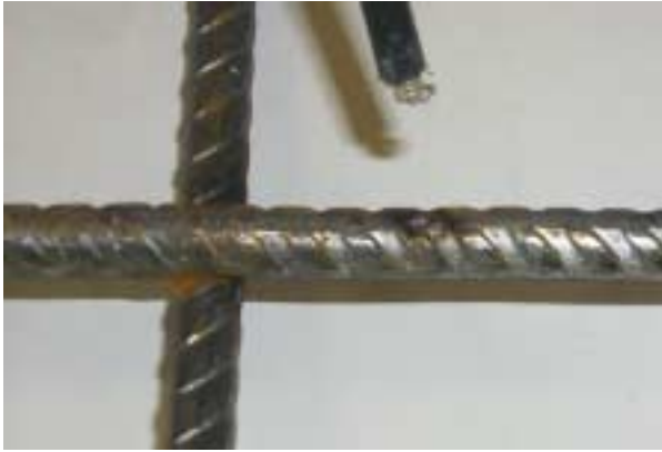
Bild 13: Prüfung der Bewehrungsstab-Kreuzung im Beton: geringfügige Ausschmelzung an freigelegter Bewehrung des Prüflings C8 nach Belastung mit 3 x 100 kA 10/350.
