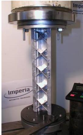
Stauchung in Hybridlängsrichtung
