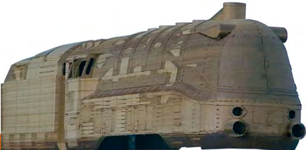
Modell einer Dampflokomotive – produziert im Schicht-Laminat-Verfahren
