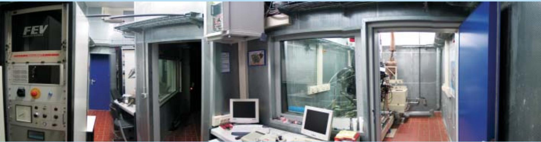
Bild 5: Die neuen Motorenprüfstände für die Anwendung von 1 bis 260 kW Motorleistung
