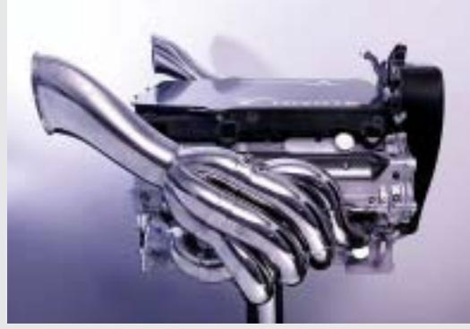
450 Kilometer war die durchschnittliche Lebensdauer des 90 kg F1-Motors in der Saison 2003, aufgrund geänderter Regeln darf ab 2004 nur ein Motor für ein Rennwochenende eingesetzt werden; die Dauerhaltbarkeit muss auf 800 Kilometer gesteigert werden – die größte technische Herausforderung in der Saisonvorbereitung.
