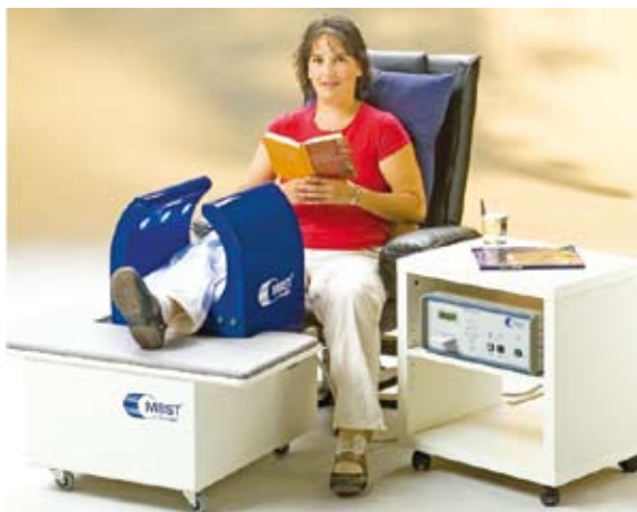
Abb. 1: MBST-Therapiegerät, bestehend aus magnetischer Spule und einer separaten Steuereinheit. Fa. MedTec Medizintechnik GmbH, Wetzlar
