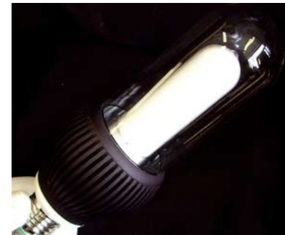
Prototyp der ersten quasi-quecksilberfreien HF-Energiesparlampe mit E27er-Schraubsockel als Ersatz für eine 100 W Glühlampe, präsentiert auf der Messe Light and Building 2012
