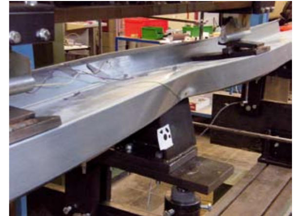
Abb. 3 | Versuche an Stahlleichtbauprofilen
