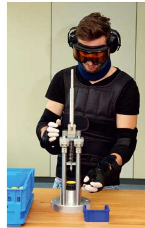
Der Altersanzug GERT an der Stanzpresse des Labors.
