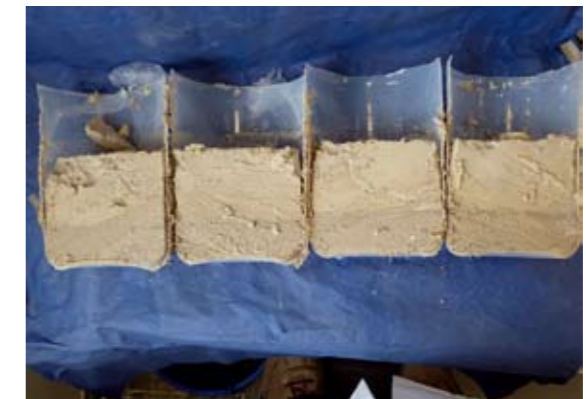
Abb. 3 | Durch Zugabe eines speziellen Bindemittels wurde die Salzlauge innerhalb einer eintägigen Einwirkdauer zu einer festen Masse umgewandelt
