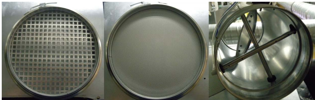
Abbildung 3-3 Verwendete Gittereinsätze mit Lochquerschnitten von 10 mm und 3 mm; Volumenstromregler (geöffnet)
