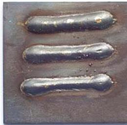
$v_s=50/90/140\text{cm/min}$ ;  $I=90\text{A}$ ;  $v_D=10\text{m/min}$
