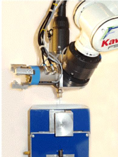
Abb. 12 Binzel Gasdüsenreinigung
