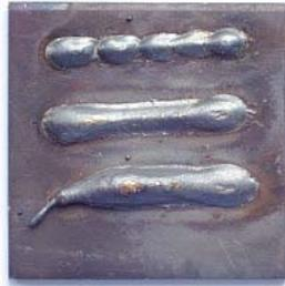
$v_s=90\text{cm/min}$  ;  $I=90\text{A}$ ;  $v_D=6/10/16\text{m/min}$
