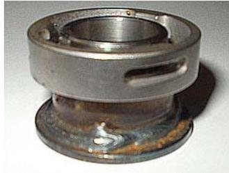
Abb. 35 Kreisbahnschweißnaht (Metallzylinder)
