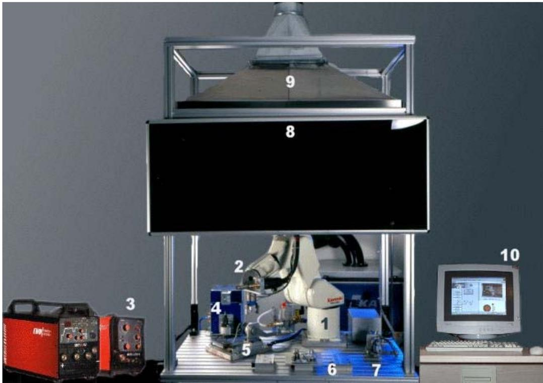
Abb. 4 Roboterschweißzelle [AKON01]
