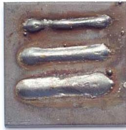
$v_s=90\text{cm/min}$  ;  $I=60/90/120\text{A}$ ;  $v_D=10\text{m/min}$
