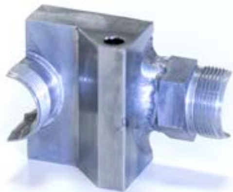
Beim Laserstrahlschweißen im Vakuum entsteht eine saubere Schweißnaht (links)
