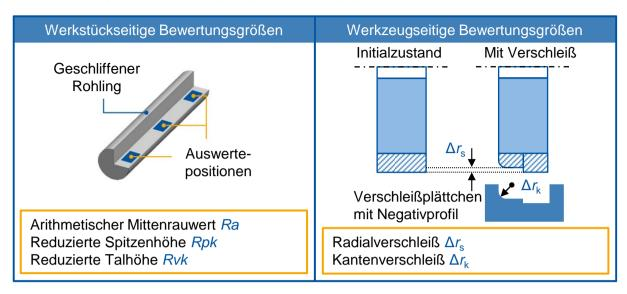
Abbildung 4.6: Bewertungsgrößen an Werkstück und Werkzeug
