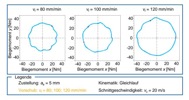
Abbildung 5.19: Polar Plots mit variierendem Vorschub v<sub>f</sub>
