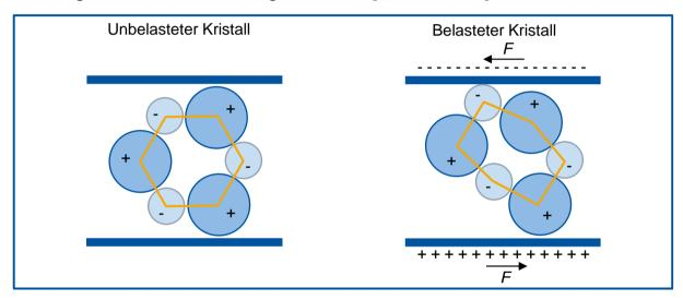
Abbildung 2.4: Piezoelektrischer Schereffekt [KLOC08, S. 392]
