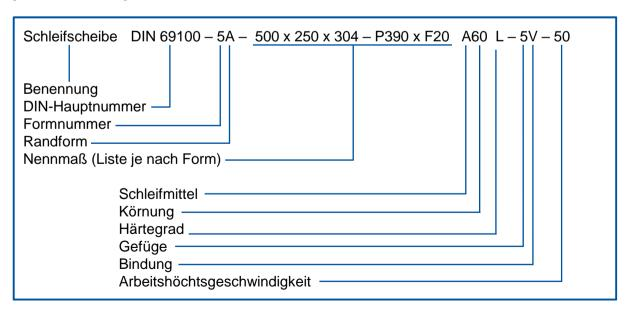
Abbildung 2.13: Zusammensetzung der Schleifscheibenbezeichnung [KLOC17, S. 52]
