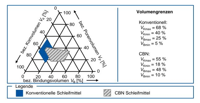
Abbildung 2.15: Volumenanteile von Schleifkörpern, Gibbsches Dreieck [KLOC17, S. 51]
