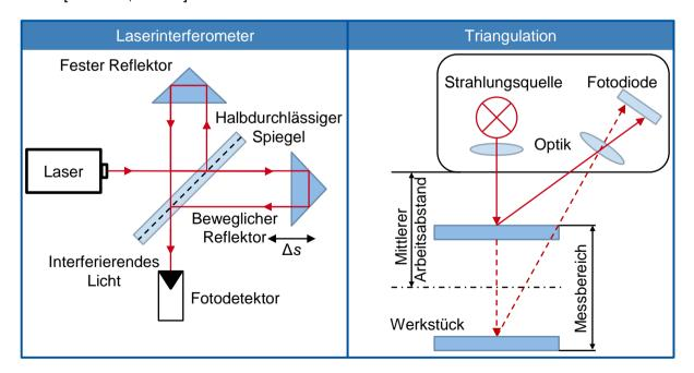
Abbildung 2.10: Messprinzipien zur Längenänderungsbestimmung [PART16, S. 180]
