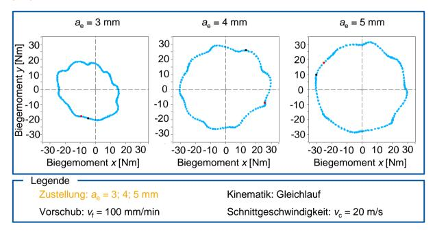
Abbildung 5.17: Polar Plots mit variierender Zustellung ae
