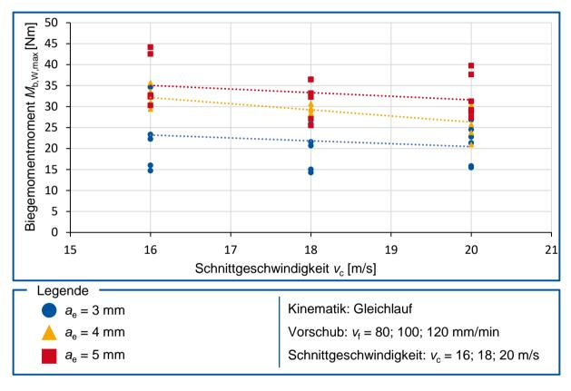
Abbildung 5.9: Biegemoment M<sub>b,W,max</sub> über Schnittgeschwindigkeit v<sub>c</sub>
