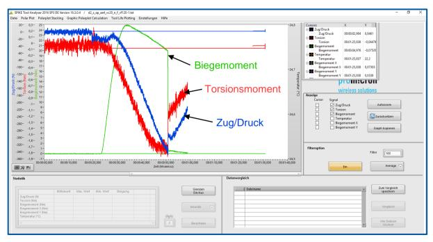
Abbildung 4.8: spike Tool Analyser, Verlauf der Messgrößen am Werkstückhalter
