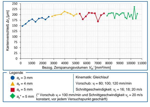
Abbildung 5.16: Kantenverschleiß Δrk der Schleifscheibe
