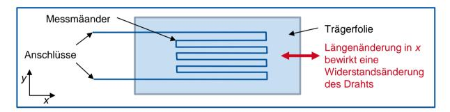
Abbildung 2.6: Grundaufbau eines Dehnungsmessstreifen [KLOC08, S. 389]
