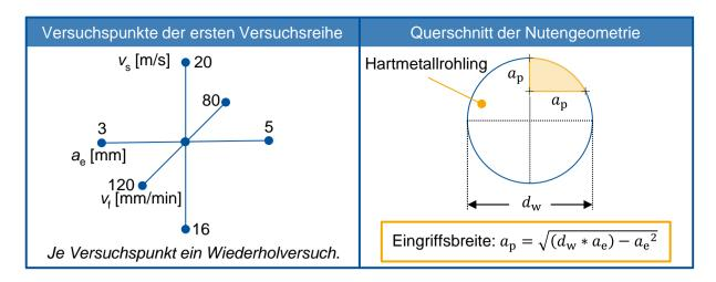
Abbildung 4.5: Versuchspunkte der ersten Versuchsreihe, Nutengeometrie
