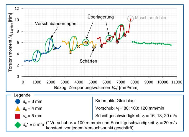
Abbildung 5.12: Einfluss der Vorschubänderung und des Schärfens der Schleifscheibe
