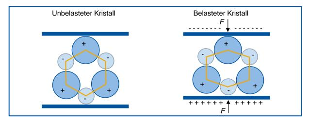
Abbildung 2.3: Piezoelektrischer Longitudinaleffekt [KLOC08, S. 391]
