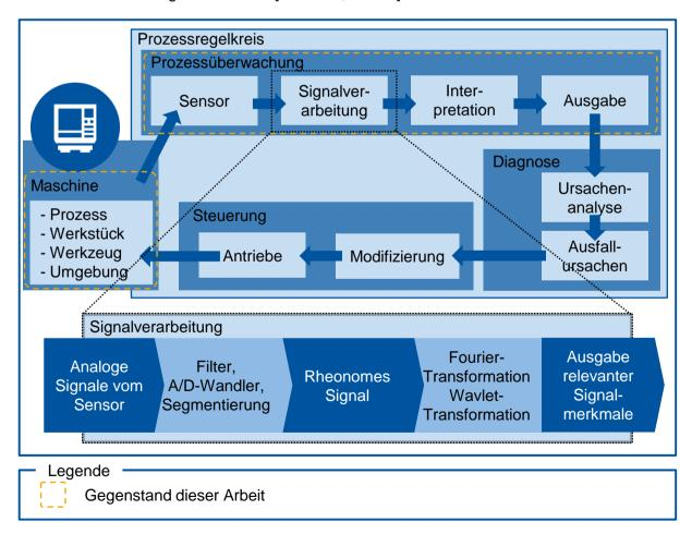
Abbildung 2.1: Prozessregelkreis bei der Prozessüberwachung [TÖNS02, S. 554]
