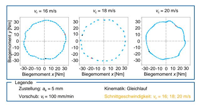
Abbildung 5.18: Polar Plots mit variierender Schnittgeschwindigkeit vc
