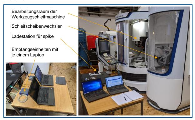
Abbildung 4.1: Versuchsaufbau, Werkzeugschleifmaschine und Messeinrichtung
