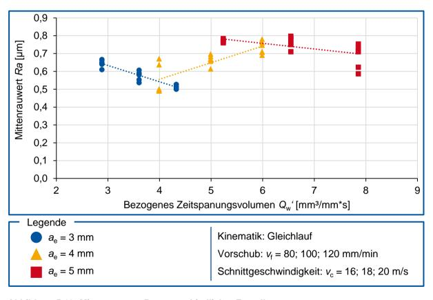
Abbildung 5.13: Mittenrauwert Ra unterschiedlicher Zustellungen
