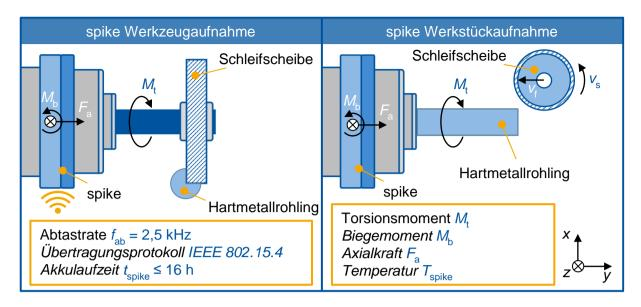
Abbildung 4.4: Schematische Darstellung der angreifenden Kräfte und Momente
