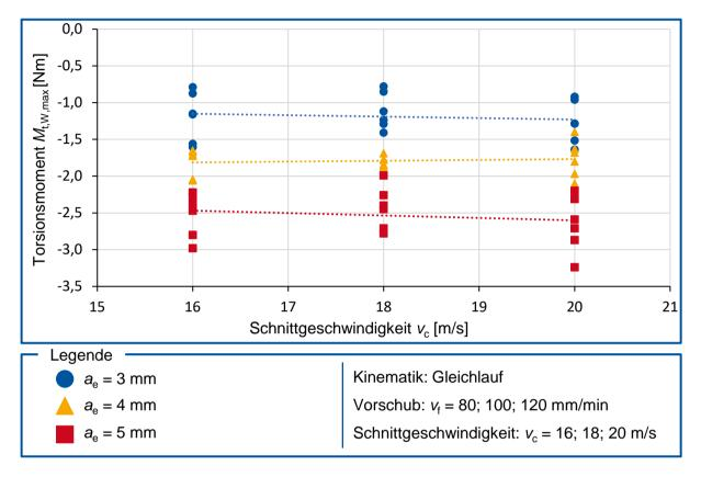
Abbildung 5.4: Torsionsmoment  $M_{t,W,max}$  über Schnittgeschwindigkeit  $v_c$
