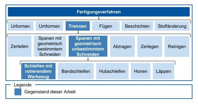
Abbildung 2.12: Schleifen als Fertigungsverfahren nach DIN 8580 [DIN03]
