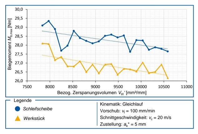
Abbildung 5.10: Biegemoment  $M_{b,max}$  über bezog. Zerspanungsvolumen  $V_W$
