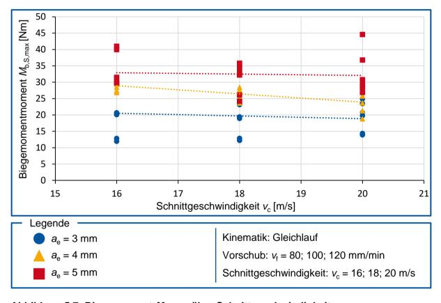
Abbildung 5.7: Biegemoment M<sub>b,S,max</sub> über Schnittgeschwindigkeit v<sub>c</sub>
