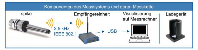
Abbildung 4.3: Messkette der Komponenten des Messystems von pro-micron
