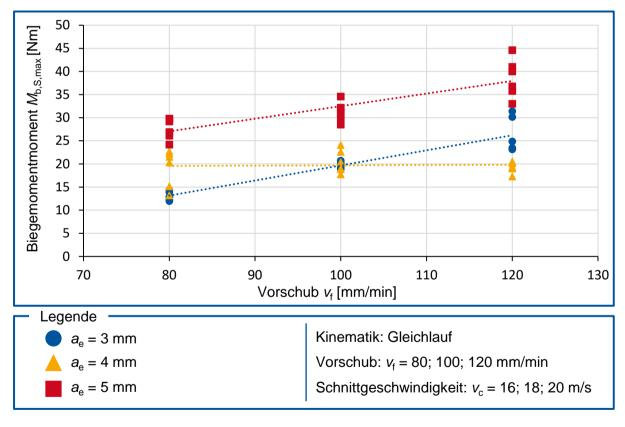
Abbildung 5.6: Biegemoment M<sub>b,S,max</sub> über dem Vorschub v<sub>f</sub>
