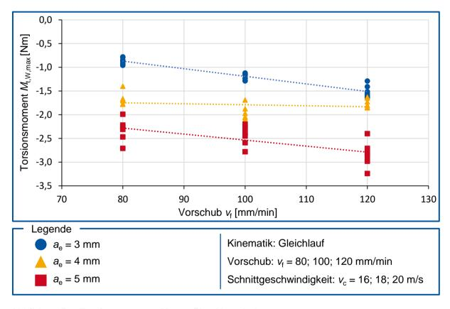
Abbildung 5.3: Torsionsmoment  $M_{\rm t,W,max}$  über Vorschub  $v_{\rm f}$
