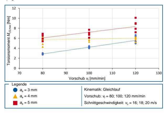
Abbildung 5.1: Torsionsmoment der Spindel Mt,S,max in Abhängigkeit des Vorschubs vf
