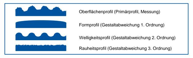
Abbildung 2.8: Überlagerung von Abweichungen am Oberflächenprofil [KEFE18, S. 112]
