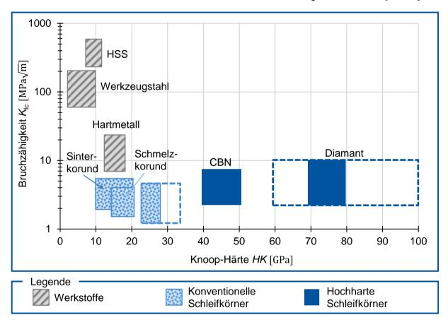
Abbildung 2.14: Bruchzähigkeit über der Härte von Schleifkornwerkstoffen im Vergleich zu Bearbeitungswerkstoffen [KLOC17, S. 24]
