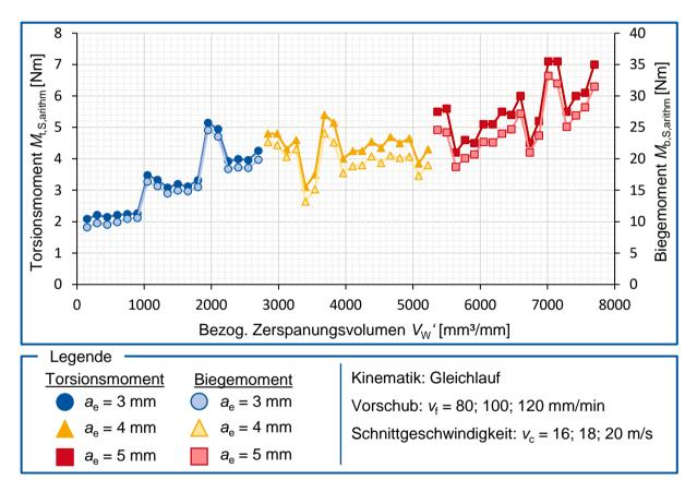
Abbildung 5.11: Vergleich von Torsionsmoment und Biegemoment
