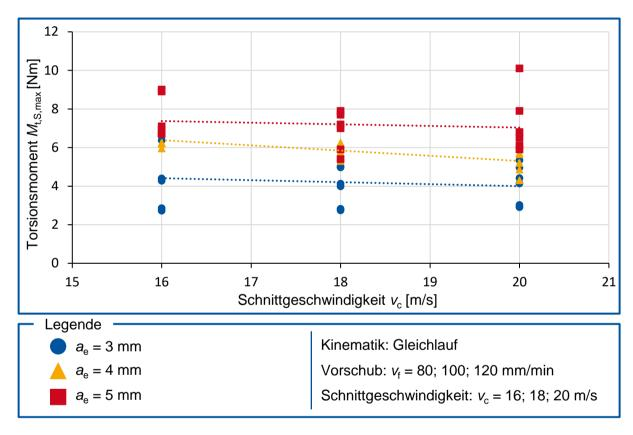
Abbildung 5.2: Torsionsmoment Mt,S,max über Schnittgeschwindigkeit vc
