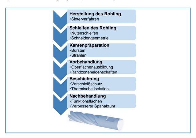
Abbildung 2.11: Prozesskette der Herstellung von Fräswerkzeugen [FRIE02, S. 18]
