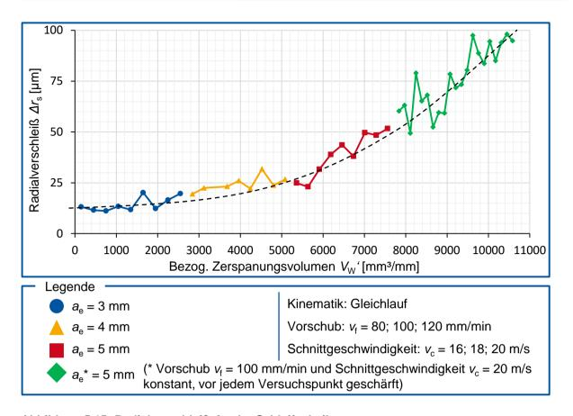
Abbildung 5.15: Radialverschleiß Δrs der Schleifscheibe
