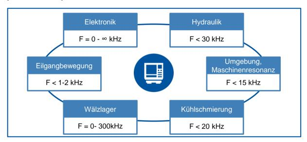
Abbildung 2.18: Störquellen der Maschinen und ihre Frequenzbereiche [KLOC17, S. 428]
