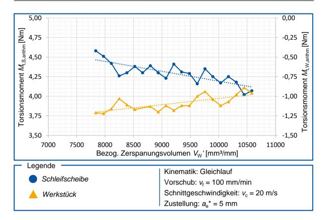
Abbildung 5.5: Torsionsmomente  $\textit{M}_{t,arithm}$  über bezog. Zerspanungsvolumen  $\textit{V}_{W}$
