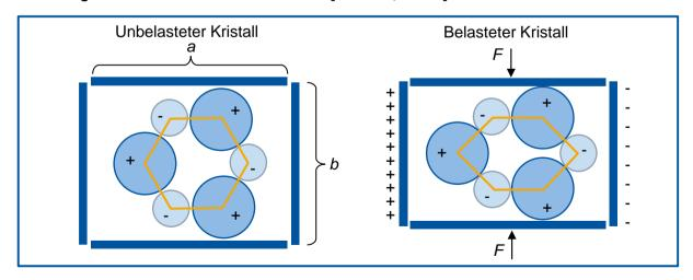
Abbildung 2.5: Piezoelektrischer Transversaleffekt [KLOC08, S. 393]
