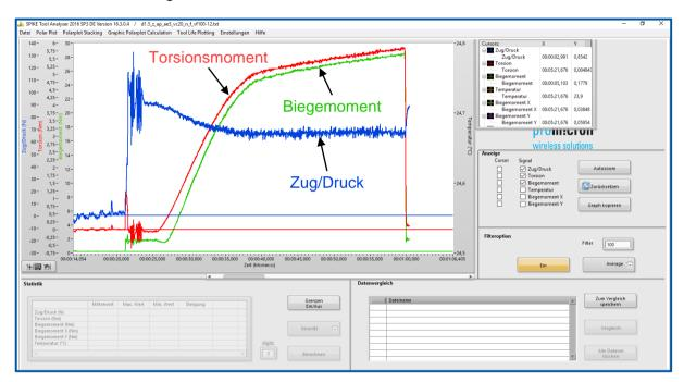
Abbildung 4.7: spike Tool Analyser, Verlauf der Messgrößen am Werkzeughalter
